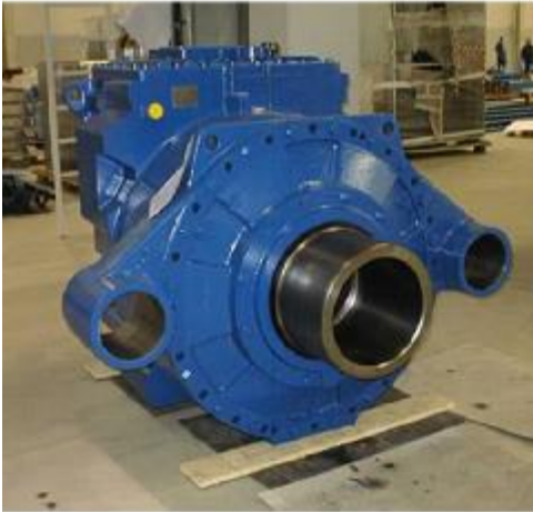
Bild 17 Dreistufiges Planeten-Stirnradgetriebe als Aufsteckgetriebe
